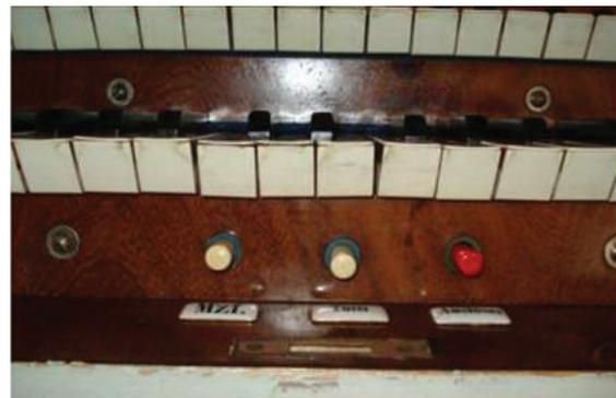
Durch Tastenheizung zerstörte Tasten und Tastenbeläge,
