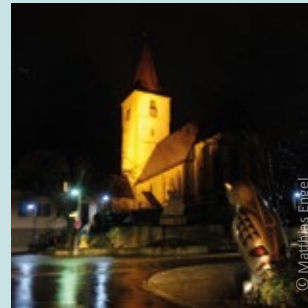
Abb.19: Schlecht gelenkte Flutlicht-Beleuchtung
