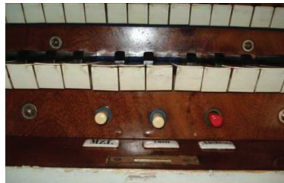
Durch Tastenheizung zerstörte Tasten und Tastenbeläge, Bild: Goethe, Orgelsachverständiger
